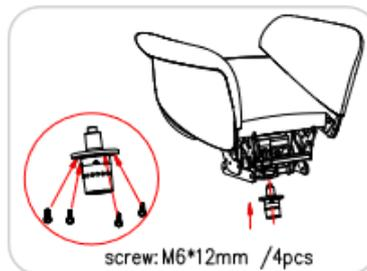
2. Fije el eje pivotante al travesaño de la parte inferior del bastidor con los tornillos (M6\*12mm/4pcs).
