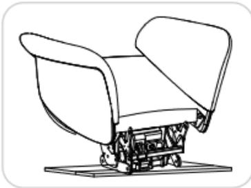
1. Retirer le siège du carton, retirez les quatre vis de la plaque inférieure.
