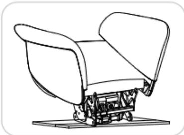
1. Extraiga el asiento de la caja de cartón, retire los cuatro tornillos de la placa inferior.
