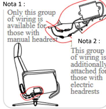
5. Conecte la caja de control al cable de salida del cojín del respaldo.
