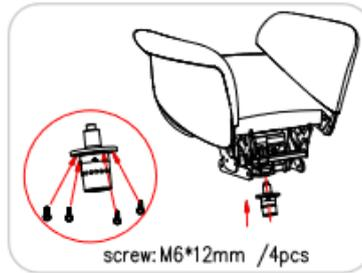
2. Fixer l'arbre pivotant sur la barre transversale en bas du cadre avec les vis (M6\*12mm/4pcs).
