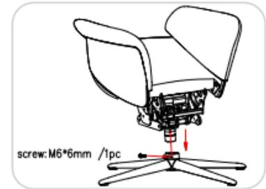
3. Insérer l'arbre pivotant verticalement dans le trou central de la base des pattes, le trou à l'extérieur de la base des pattes aligné avec le trou sur le côté de l'arbre pivotant avec les vis (1 / M6 \* 6MM).
