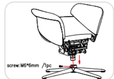
3. Inserte el eje giratorio verticalmente en el agujero central en la base de las patas, con el agujero en el exterior de la base de las patas alineadas con el agujero en el lado del eje giratorio con los tornillos (1 / M6 \* 6MM).
