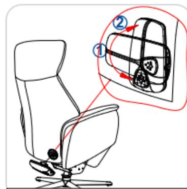
6. ① Insérer le bloc-batterie dans le sens de l'emplacement de la carte.
