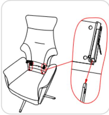
4. Alinee los cierres del cojín del respaldo con el cierre del asiento y presione firmemente el cierre. La instalación estará completa cuando oiga el "clic".
